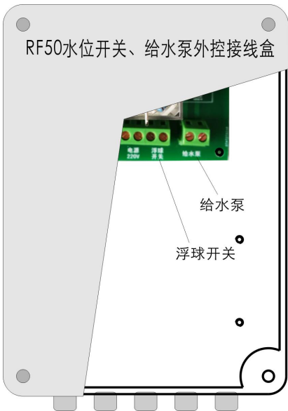
图 10：RF50（进水电动阀）内部输出单接点软化水箱液位开关、给水泵接线盒
